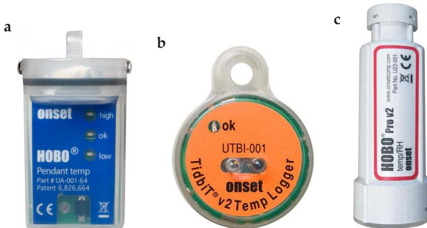
Figura 2. Sensores térmicos: modelos Hobo (a), Tidbit (b) y ProV2 Onset (c) utilizados para el registro de temperaturas y humedad relativa en el monitoreo de nidos de tortugas marinas y cocodrilos.
