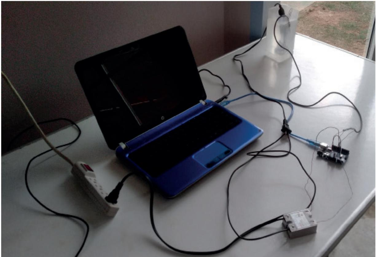
**Figura 7.** Conexión física de los componentes que conforman el control de temperatura.
