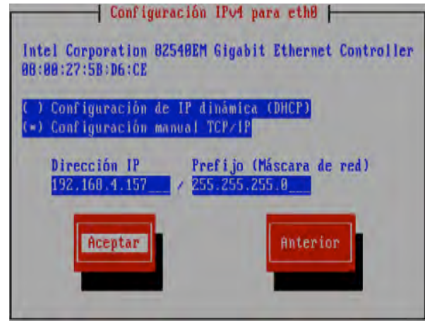
Figura 12. Configuración IPv4 para eth0.
