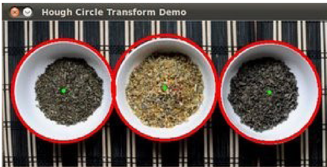
Figura 5. Ejemplo de la aplicación de la transformada de Hough para la detección de círculos en una imagen.
