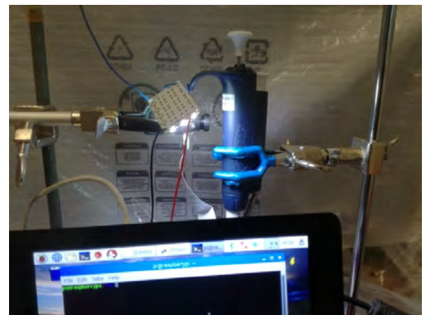
Figura 6. Montaje del sistema de detección del volumen de la micropipeta.
