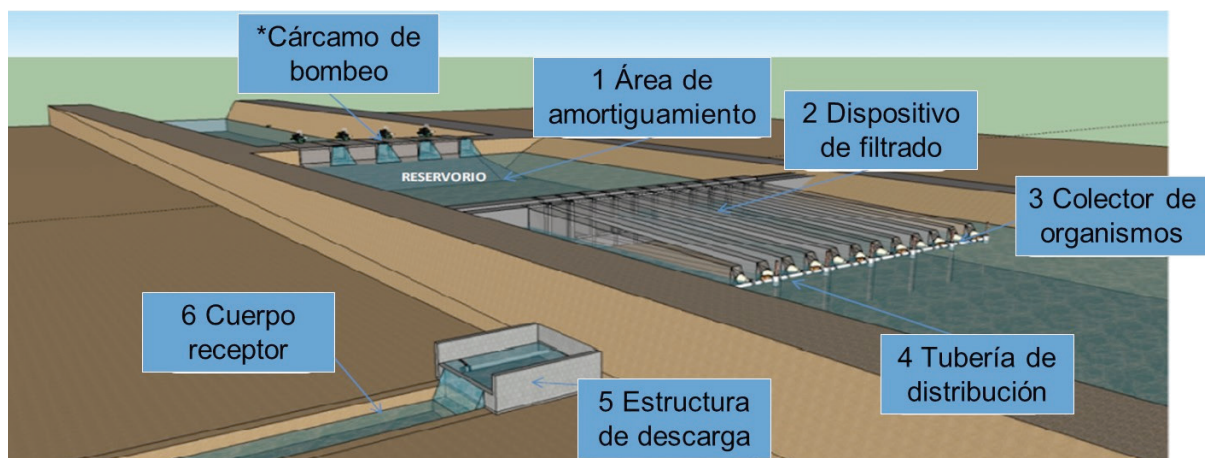
Figura 3. Esquema general de un SEFA (1-6: secuencia de funcionamiento del sistema; Aguirre-Villaseñor et al. 2011).
